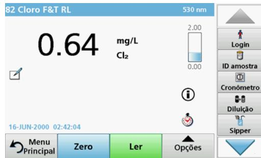
3. Coloque o tubo de alimentação na solução da amostra e pressione **LER**.
