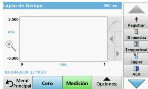
4. Coloque la manguera de alimentación en la solución de muestra y presione **READ** (leer).
