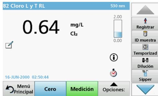
3. Coloque la manguera de alimentación en la solución de muestra y presione **READ** (leer).
