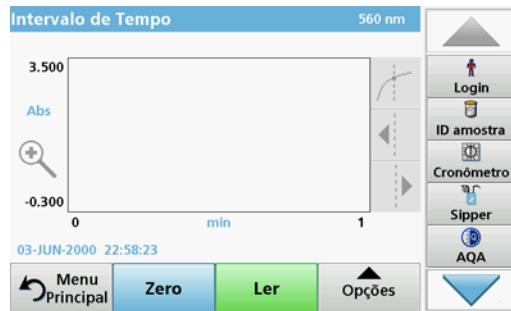
4. Coloque o tubo de alimentação na solução da amostra e pressione LER.
