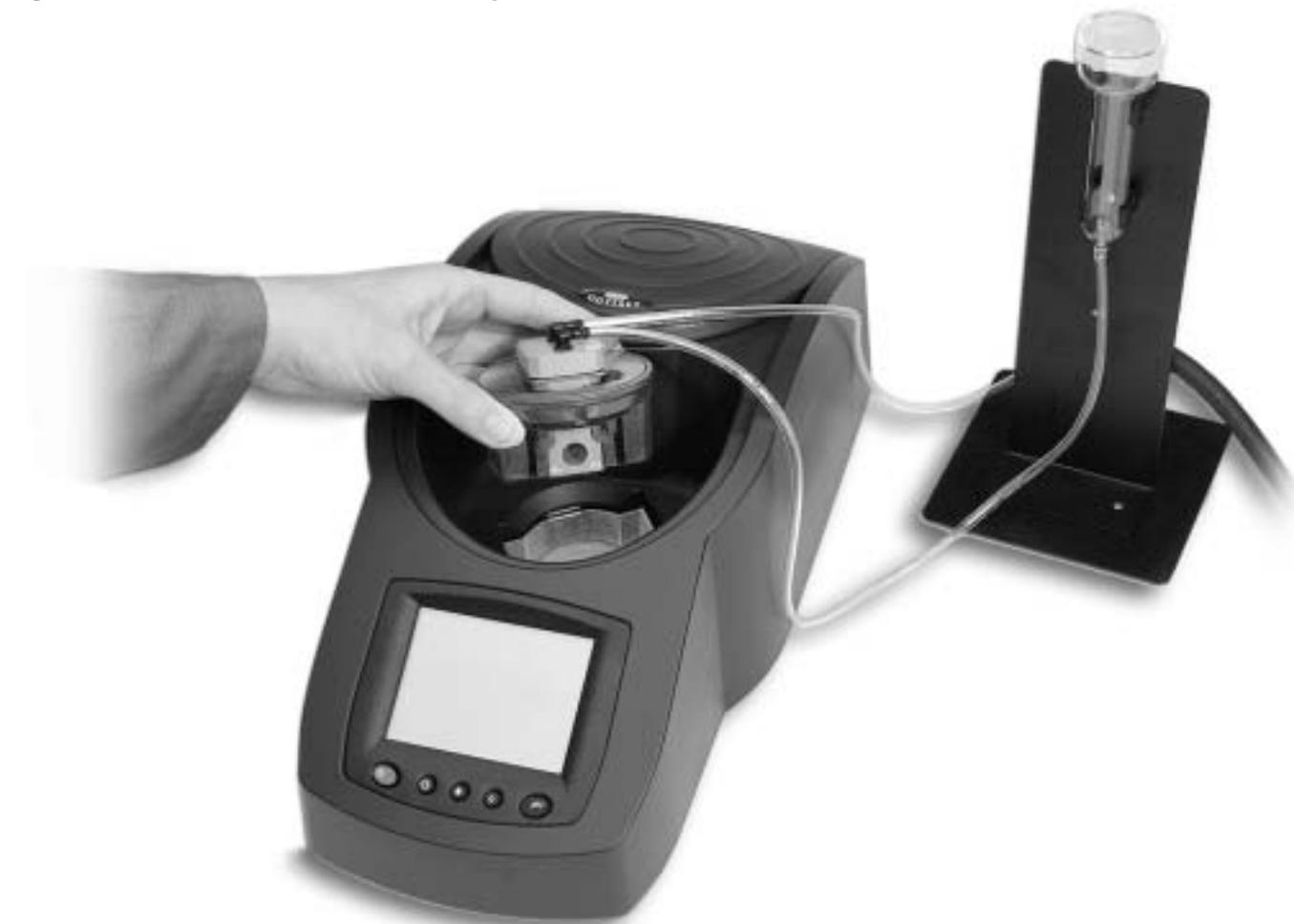
**Nota:** La celda de flujo no puede ser usada directamente con los programas Hach a menos que esto sea especificado en el procedimiento. El uso de la celda de flujo con otros programas Hach requiere ajustes estándar.
