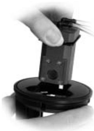
Figura 8 Instalación de la celda de flujo continuo
