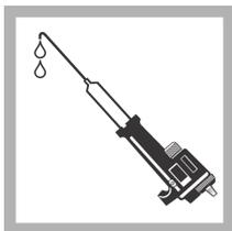
2. Tournez le bouton de distribution pour chasser de l'air et quelques gouttes de titrant. Remettez le compteur à zéro et essuyez la pointe.
