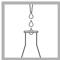
2. A l'aide d'une pipette volumétrique, ajoutez l'échantillon dans un Erlenmeyer propre de 250 ml. Voir [Détermination de la bonne taille d'échantillon](#) à la page 32.
