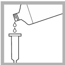
1. Remplissez une cartouche de titrage vide et propre de réactif 3.
