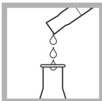
8. A l'aide d'une éprouvette graduée, ajoutez 8 ml de réactif 2 dans l'Erlenmeyer.
