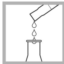
6. A l'aide d'une éprouvette graduée, ajoutez 8 ml de réactif 2 dans l'Erlenmeyer.
