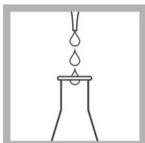
**7.** A l'aide d'une pipette volumétrique, ajoutez 5,0 ml de réactif 1 dans un Erlenmeyer.
