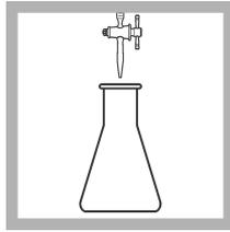
8. Agitez le ballon pendant le titrage avec du réactif 3 pour qu'il passe du rouge au bleu pur.
