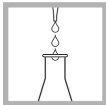
4. A l'aide d'un compte-gouttes gradué, ajoutez 1 ml de réactif 1 dans l'Erlenmeyer.
