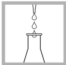
2. A l'aide d'une pipette volumétrique, ajoutez 20 ml d'étalon 2 dans un Erlenmeyer de 250 ml.
