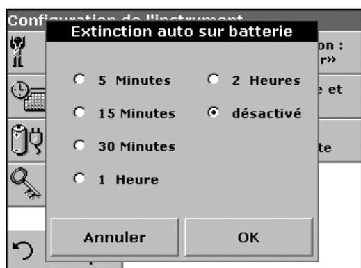
3. Sélectionnez une option sous **Extinction auto sur batterie** pour définir la durée de la période d'inactivité qui peut s'écouler avant que l'instrument se mette automatiquement hors tension, si l'instrument est alimenté sur pile.
