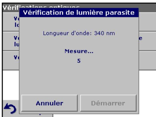
4. Insérez la cuve/cellule d'échantillon/filtre à référence dans le compartiment pour cuves n° 2. Fermez le compartiment pour cuves. Appuyez sur **Démarrer**.
