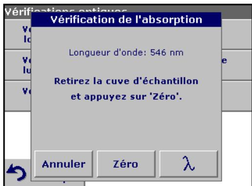
Le test Vérification de l'absorption sert à évaluer l'exactitude photométrique et la répétabilité de l'instrument.
