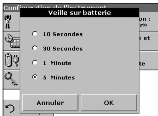
2. Sélectionnez une option sous **Veille sur batterie** pour définir la durée de la période d'inactivité qui peut s'écouler avant que l'instrument passe en mode de veille, si l'instrument est alimenté sur pile.
