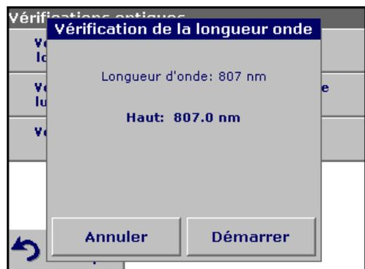
3. Le résultat qui s'affiche doit être comparé à la consigne (indiqué sur le certificat de contrôle qualité) de la cuve/cellule d'échantillon.
