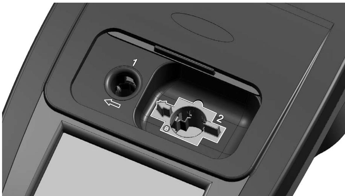
Tableau 1 Installation des adaptateurs pour cuves/cellules d'échantillon
