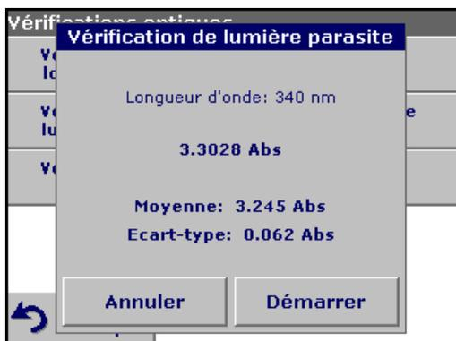
5. La moyenne et l'écart-type sont calculés à partir de 100 mesures consécutives de l'absorption. Le résultat qui s'affiche doit être comparé à la consigne (indiqué sur le certificat de contrôle qualité) de la cuve/cellule d'échantillon.
