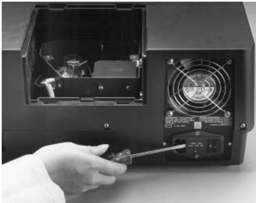
**Suivre les instructions ci-dessous pour remplacer les fusibles du spectrophotomètre DR/4000.**
